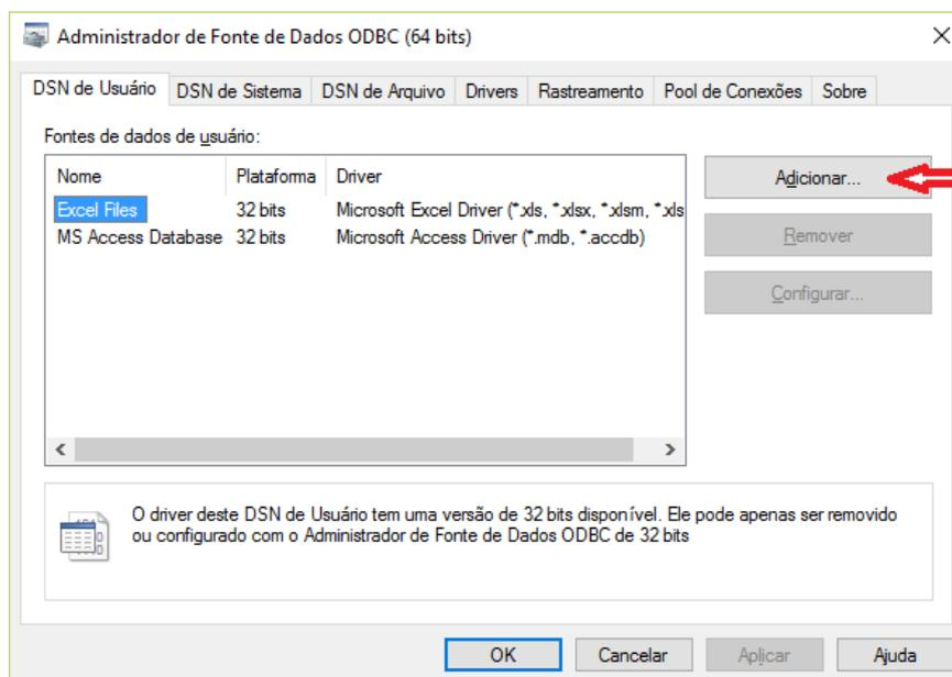
Clique sobre a opção adicionar para criar uma nova conexão ODBC.
